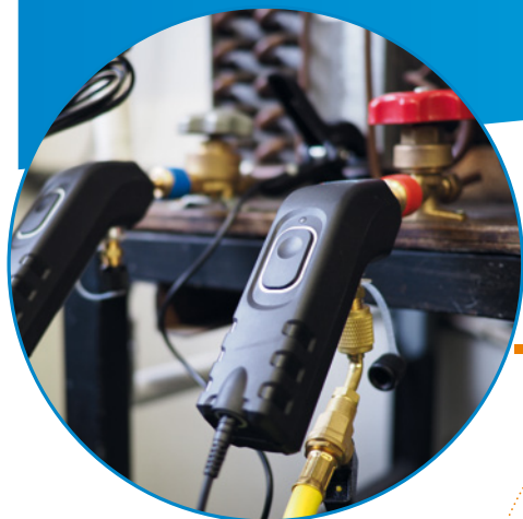
MESURE SUR GROUPE FROID À L'AIDE DU SI-RM3
