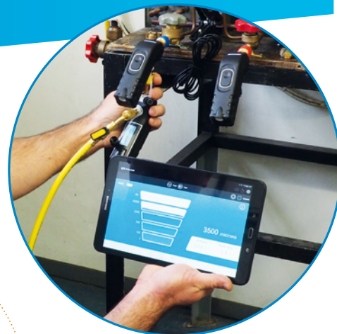
MESURE DU TIRAGE AU VIDE AVEC DU VACUOMÈTRE SI-RV3
