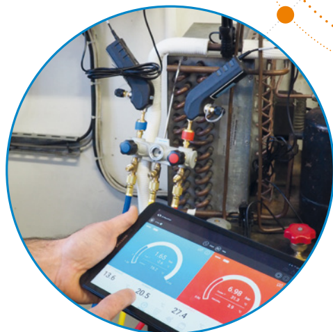
CONTRÔLE AVEC MANIFOLD COMBINÉ SI-RM13
