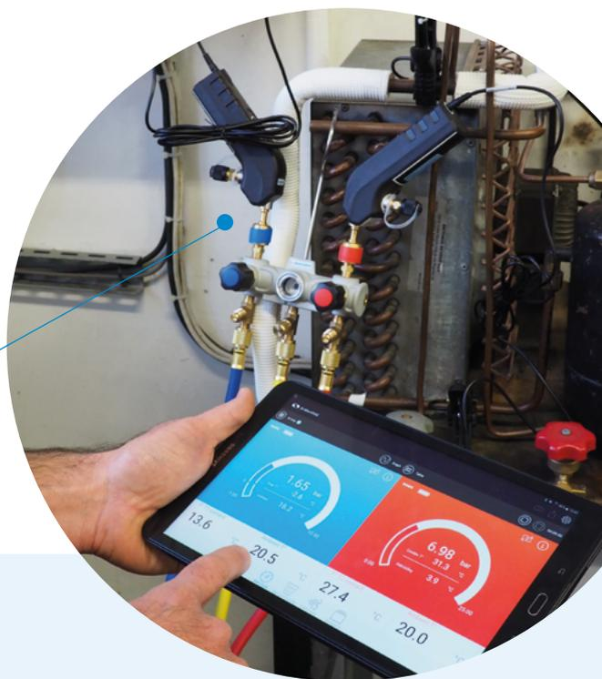
Cet appareil permet à l'utilisateur de mettre en service une pompe à chaleur, de vérifier l'étanchéité du circuit frigorifique ou le gaz de remplissage et de contrôler simultanément la pression différentielle et les températures de sous-refroidissement/surchauffe.
