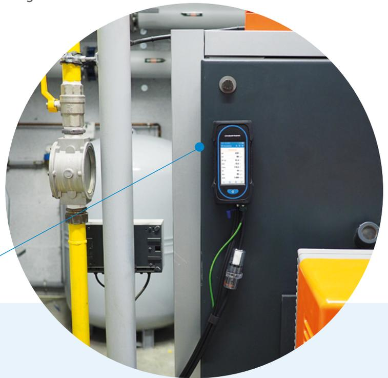
Pour l'analyse complète de la combustion d'une chaudière domestique ou tertiaire ou d'un four avec un test de rendement, des mesures des émissions de CO et de NO<sub>x</sub>, un calcul du CO<sub>2</sub> avec une surveillance de CO ambiant, ainsi que des mesures de tirage (pression) et de température.
