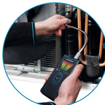
DÉTECTION DE FUIE DE FLUIDE FRIGORIGÈNE SUR GROUPE FROID
