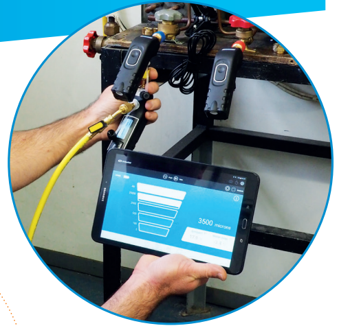
MESSEN DER EVAKUIERUNG MIT DER VAKUUMSONDE SI-RV3
