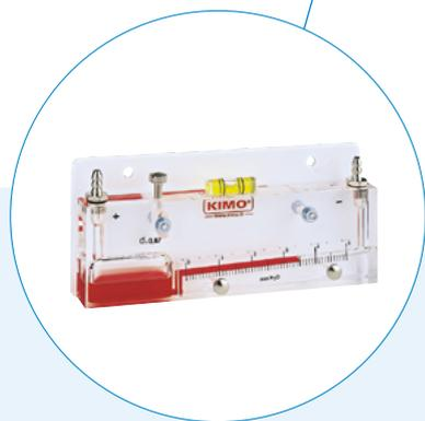
Affichage permanent de la pression différentielle à l'entrée des salles propres à l'attention des techniciens de laboratoires, sans nécessité d'alimentation électrique.
