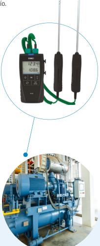
Calcular el recalentamiento y subenfriamiento de un sistema de refrigeración por cambio de fase con un termómetro de doble entrada, cuando se utilizan colectores analógicos.
