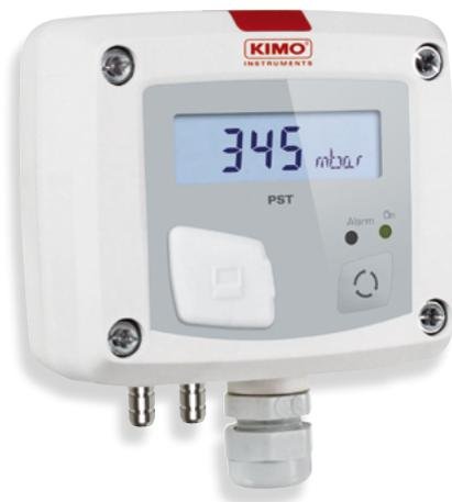
Die Monostate sind schnell zu installieren und einfach zu parametrieren. Sie können einen Alarm auslösen, wenn ein zuvor konfigurierter Schwellenwert überschritten wird, und diese Information dann über ein Relais senden. Die Einstellung des Alarms erfolgt einfach über einen Druckknopf oder mit Hilfe der Software LCC-S, die mit den Monostaten der Serien 110, 210 und 310 kompatibel ist.
